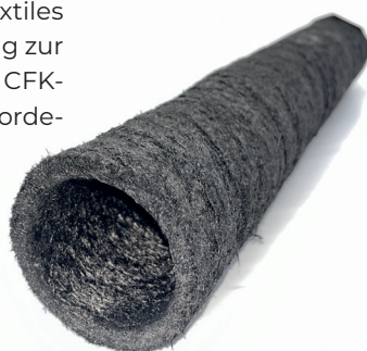
Rundvernadelte Preform aus Carbonfaservliesstoff, Innendurchmesser 60 mm
