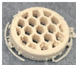
Gepresstes Profil aus Kurzfaser Flachs/Sisal mit Pilzmyzelmatrix
