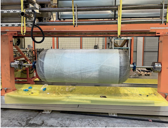
Liner aus PA6 und Boss-Elemente als integrierte Kernstruktur
