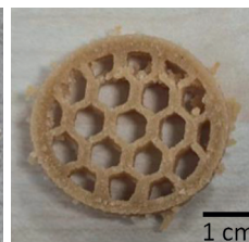
Liquid Deposition Modelling (LDM) – 3D-gedrucktes monolithisches Bauteil aus reinem Myzel: „nass“ nach dem Druck (li.), nach Trocknung (re.)
